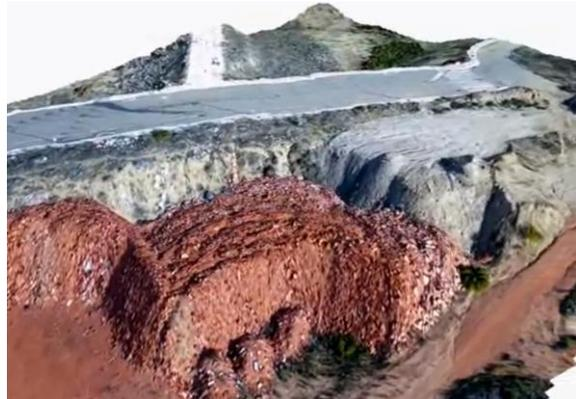
**Ilustración 5 Modelo Digital de Elevaciones en zona de vertido generado a partir de vuelo con UAV**
